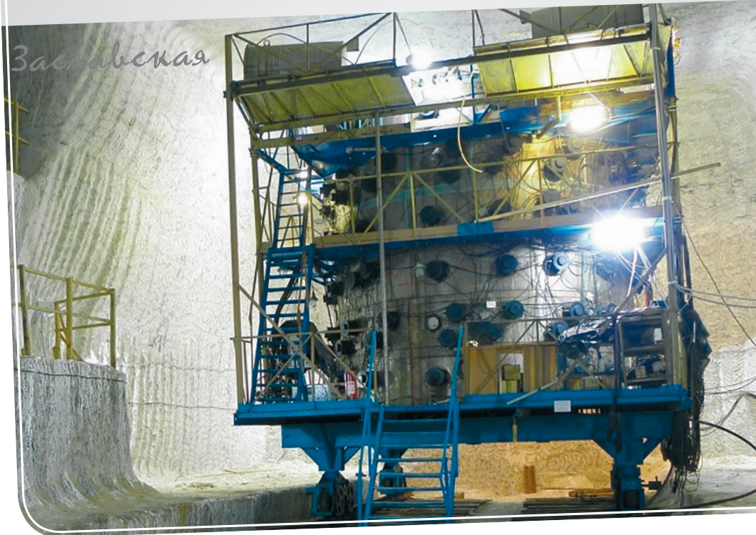
АСД. Высота детектора – 5,47 м, диаметр – 5,56 м
